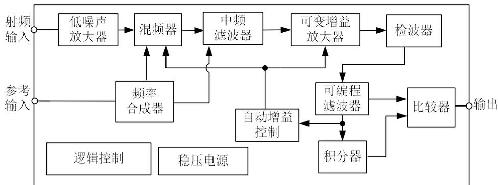
WL217型433MHz短距离无线通讯接收机电路原理框图
